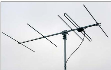
Bild 5: 5-Element-50-Ω-Yagi mit Faltdipol, industriell gefertigt von Konni-Antennen [8]
