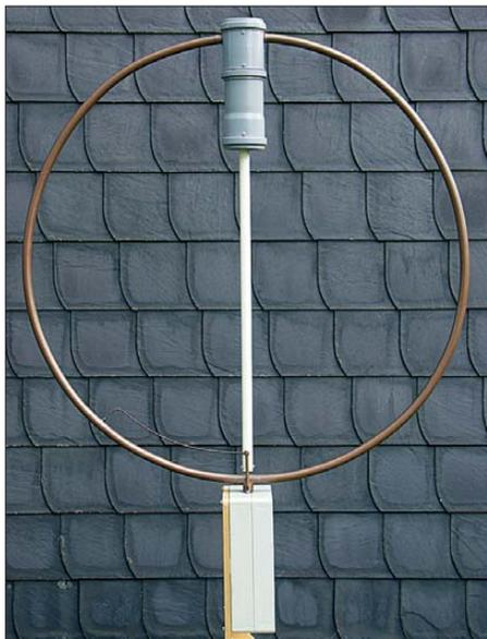
**Bild 1: Magnetantenne mit automatischem Anpassgerät**
