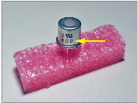
**Bild 6: Die Empfindlichkeitsklasse ist auf den Sensor gedruckt.**
