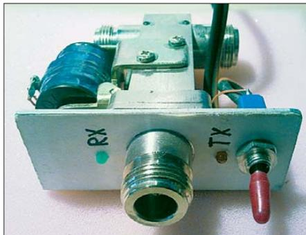
**Bild 6: Separate Baugruppe zur Sende-Empfangs-Umschaltung**
