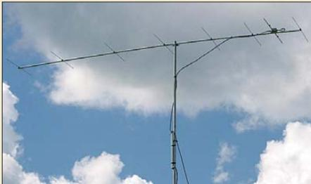
DK7ZB hat in den vergangenen anderthalb Jahrzehnten zahlreiche Varianten von 2-m-Yagi-Antennen im FA und andernorts veröffentlicht. Dieser Beitrag soll den Überblick erleichtern und Entscheidungshilfen für Bau und Einsatz der Yagis geben. Das Foto zeigt eine 8-Element-Yagi in Leichtbauweise, die sich gut zum Stocken eignet.
