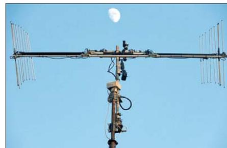
**Bild 5:** Um dem Faraday-Effekt zu begegnen, kann Steffen Minack, DD0VF, seine beiden 9-Element-Yagis innerhalb von 6 s von horizontaler auf vertikale Polarisation drehen, wie [5] zeigt.
