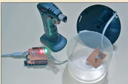
Das auf dem Gassensor TGS2610 basierende Warngerät eignet sich zum Signalisieren zu hoher Gaskonzentrationen im Innenraum von Fahrzeugen, die mit Gas angetrieben werden. Es ist auch in Gebäuden einsetzbar, in denen z. B. mit Propan oder Isobutan betriebene Geräte Verwendung finden. Foto: Sander
