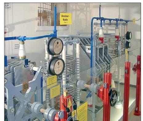
**Bild 4:** Abstimmereinheit der MW-Sendeantenne für 474 kHz und 500 kHz
