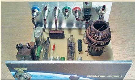
Am 4. Oktober jährt sich der Start des ersten Satelliten – Sputnik 1 – zum 55. Mal. Der Beitrag zeigt eine mutmaßliche Schaltung des Senders, die von im Umgang mit Röhren versierten Funkamateuren nachgebaut werden kann. Mit knapp 1 W Sendeleistung auf der QRP-Frequenz 21,060 MHz lassen sich (nicht nur) am Tag des Jubiläums QSOs mit Gleichgesinnten tätigen.
